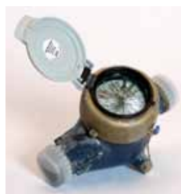
■ Von Frost zerstörter, geborstener Wasserzähler
